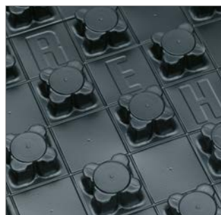
Sl. 4-12 Gornja strana pečurkaste ploče Varionova sa donjom zvučnom izolacijom 30-2 30-2 i donjom toplotnom izolacijom 11 mm, odn. 40 mm
